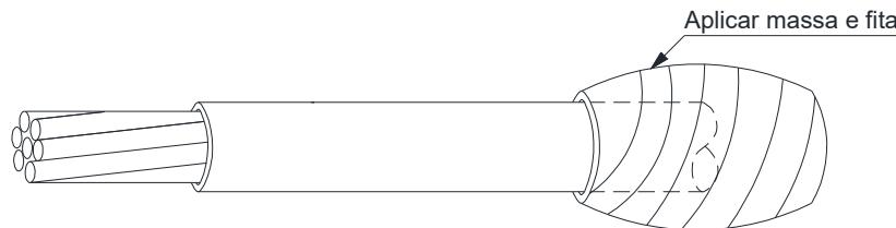
Figura 106 – Conexões e emendas – Rabicho
