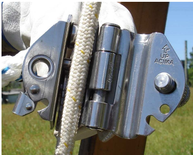
Figura 33 – Instalação do trava-quedas na linha de vida
